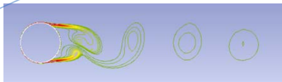
图 8 多尺度湍流模型瞬时无量纲涡量等值线图 Fig. 8 Instantaneous non-dimensional vorticity contours of multiscale turbulent model
